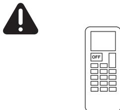
Éteindre d'abord le système à l'aide de la télécommande avant de couper l'alimentation électrique en cas de dysfonctionnement.
