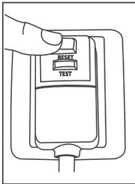
Le cordon d'alimentation contient un dispositif de courant qui détecte la détérioration du cordon d'alimentation. Pour tester votre cordon d'alimentation procédez comme suit :
