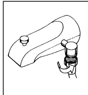
La sortie de dérivation sur le côté du bec est pour un raccordement de tuyau pour actionner une douche de main. Utilisez l'une ou l'autre des extrémités du tuyau flexible. Serrez à la main l'écrou du tuyau sur la sortie du déviateur du bec
