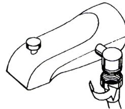
La salida del desviador en el lado del pico es para una conexión de manguera para operar una ducha de mano. Utilice cualquiera de los extremos de la manguera flexible. Apriete la tuerca de la manguera en la salida del desviador del pico.
