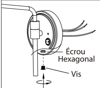
4. Remplissez le trou de sortie par l'écrou hexagonal et la vis.
