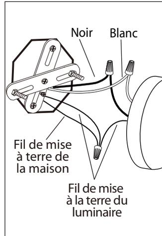
7. Branchez les fils de la mise a terre (cuivre nu ou vert) de votre montage au fil de la mise a terre (cuivre nu ou vert) ou vis de la mise a terre dans la boîte électrique. Reliez le fil noir (ou fil marqué « SPT-2») du luminaire au fil noir dans la boîte de sortie et reliez le fil blanc (ou le fil rainuré) du luminaire au fil blanc dans la boîte de sortie.
