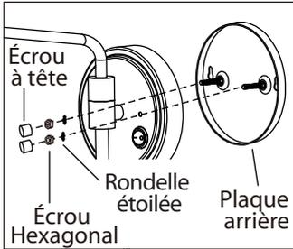
1. Retirez la plaque arrière du luminaire en dévissant les écrous à tête, les écrous hexagonaux et les rondelles étoilées.
