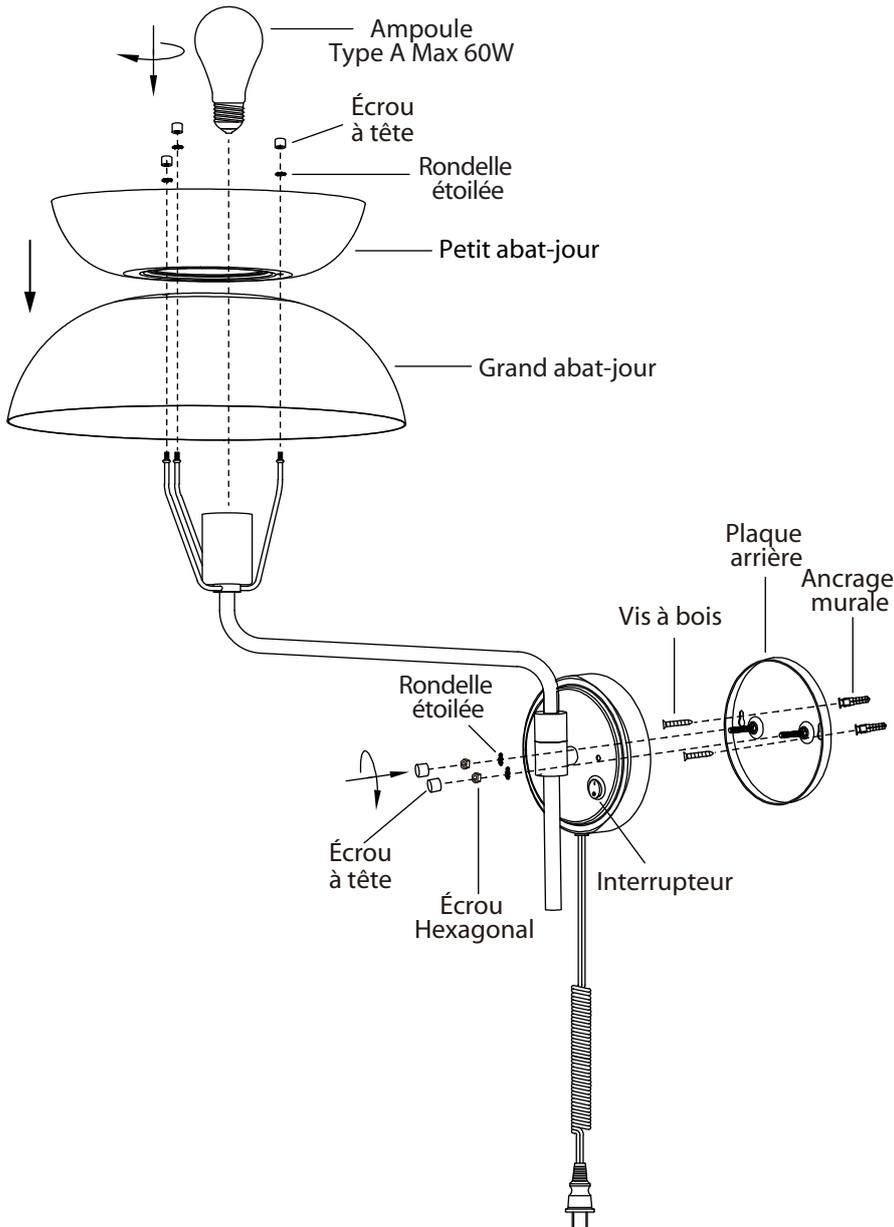
1. Retirez la plaque arrière du luminaire en dévissant les écrous à tête, les écrous hexagonaux et les rondelles étoilées.
