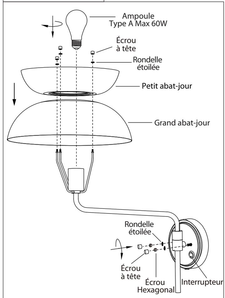
9. Placer le luminaire sur les goujons sur la ferrure de montage. Sécurisez le luminaire en place avec les rondelles étoilées, les écrous hexagonaux et les écrous à tête.
