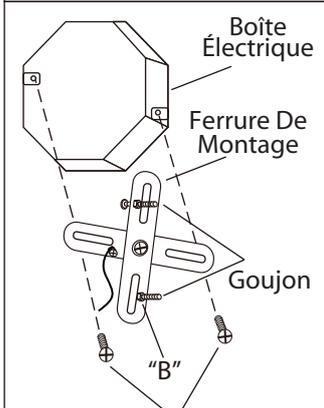
5. Dévissez l'écrou B. Ajustez le poteau à la longueur désirée et barrez en place avec cet écrou. Posez la ferrure d'installation à la boîte de sortie électrique à l'aide des vis de la boîte (en sus). Assurez-vous que les goujons de la ferrure d'installation font face vers l'extérieur de la boîte électrique.
