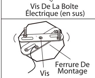
6. Placez la ferrure d'installation de façon à ce que le luminaire soit placé correctement lorsqu'il sera posé au plafond. Serrez la vis pour retenir la ferrure en place.
