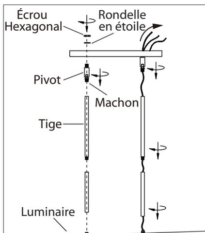
4. Installez la longueur de colonne requise en faisant passer le fil dans la colonne puis en vissant la colonne sur le luminaire. Installez le pivot sur la colonne en vous assurant que le manchon est au niveau du pivot.
