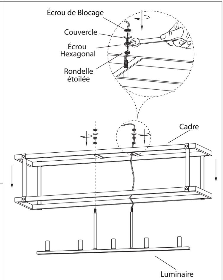
2. Retirez les écrous de blocage, le couvercle, les écrous hexagonaux et les rondelles étoilées du luminaire. Insérez les fils à travers les trous du cadre et positionnez le luminaire au cadre tel qu'indiqué.
