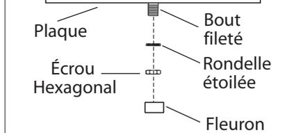
10. Posez le plateau au bout fileté en serrant à l'aide des écrous étoilés et des écrous hexagonaux. Vissez le fleuron au bout fileté.
