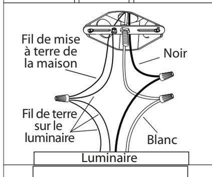
8. Branchez les fils de la mise a terre (cuivre nu ou vert) de votre montage au fil de la mise A terre (cuivre nu ou vert) ou vis de la mise a terre dans la boîte électrique. Posez le fil noir de la fixture au fil noir dans la boîte électrique et posez le fil blanc de la fixture au fil blanc dans la boîte.
