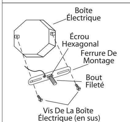
6. Posez le bout fileté à la ferrure de montage. Ajuster afin que le trou à l'arrière du luminaire soit dégagé et barrer en place à l'aide du bout fileté de la rondelle étoilée et l'écrou hexagonal. Posez la ferrure de montage à la boîte électrique à l'aide des vis (en sus).
