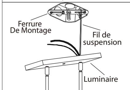
7. Utiliser le fil de suspension pour suspendre le luminaire tel qu'illustré afin de faciliter la connexion des fils.
