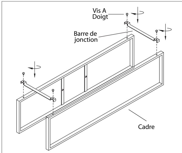
1. Retirez les vis qui se retrouvent déjà sur le cadre. Positionnez le cadre tel qu'indiqué. Installez les 4 barres de jonction au cadre en resserrant les vis.
