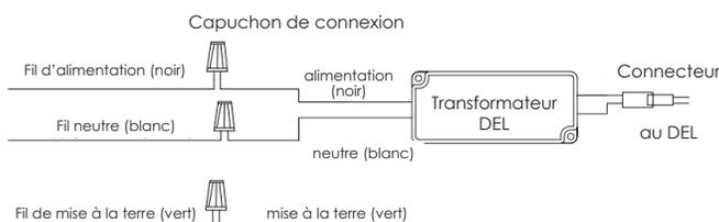
Schéma de câblage sans photocellule
