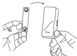
Séparant le contact magnétique du capteur, le voyant de la zone de récepteur cesse de clignoter.
