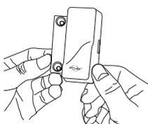
Lorsque le contact magnétique touche au détecteur, le récepteur n'émettra pas de signal sonore.
