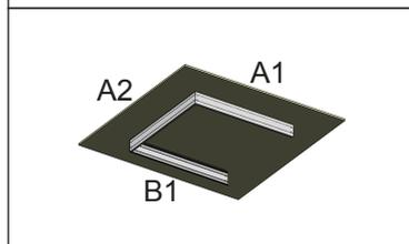
2. Fixez le cadrage au plafond avec des vis (en utilisant des ancrages approuvés). Retirez la pièce de cadre B2 comme indiqué sur l'image 1.
