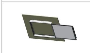
3. Glissez le luminaire partiellement dans cadrage de montage tel qu'indiqué. L'alimentation étant coupée au niveau du disjoncteur, connectez l'alimentation au pilote en fonction du schéma de câblage.
