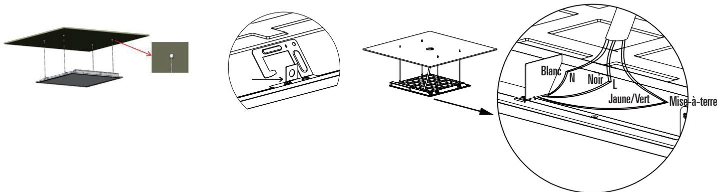
2. L'alimentation étant coupée au disjoncteur, connectez l'alimentation au pilote en fonction du schéma de câblage pour terminer l'installation.
