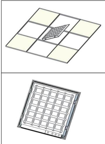
1. Retirez la dalle de plafond à un endroit approprié où le produit doit être installé et soulevez le produit au-dessus de la barre.
