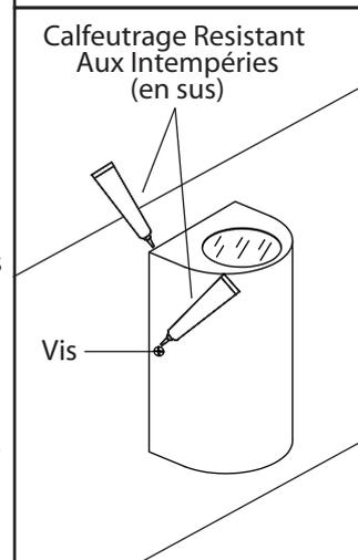
5. Après l'installation, scellez autour des périmètres du haut et des cotés avec un scellant contre les intempéries. Le dessous ne devrait pas être scellé pour prévenir une accumulation d'humidité. Appliquer une petite quantité de scellant résistant aux intempéries tout autour du périmètre entre la vis et la plaque d'installation.
