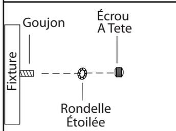
3. Une fois les connexions terminées, poussez soigneusement les fils et les marrettes dans la boîte électrique en vous assurant qu'aucun fil dénudé (sur les fils noirs et blancs) est visible des marrettes. Posez le luminaire au mur en alignant le trou(s) du luminaire avec les goujons ou tiges filetés sur la ferrure de montage. Fixez en place à l'aide des écrous à têtes et des rondelles étoilées.
