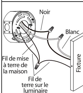
2. Brancher les fils de la mise à terre (cuivre nu ou vert) de votre luminaire au fil de la mise à terre (cuivre nu ou vert) ou vis de la mise à terre dans la boîte électrique. Poser le fil noir de la fixture au fil noir dans la boîte électrique et poser le fil blanc de la fixture au fil blanc dans la boîte.
