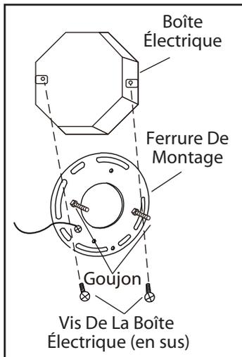
1. Posez la ferrure d'installation à la boîte de sortie électrique à l'aide des vis de la boîte (en sus). Assurez-vous que les goujons de la ferrure d'installation font face vers l'extérieur de la boîte électrique.
