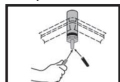
Le **DS-2800** est fourni avec un tube de protection contre le débordement qui doit être installé dans le trou au fond du bac à eau. Bien qu'il soit fortement recommandé d'utiliser cet équipement, si vous ne désirez pas l'utiliser ou si vous n'avez pas de drain de plancher, laissez le capuchon en vinyl installé en usine sur l'extrémité du tube.
