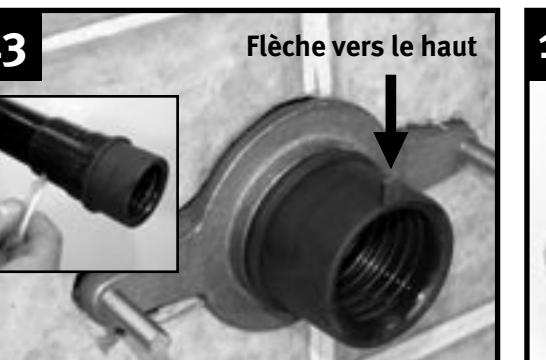
Lubrifier soigneusement l'extérieur du manchon de caoutchouc et l'intérieur de la surface cannelée. Insérer le tube et le manchon en plaçant la flèche vers le haut. Lubrifier le renvoi du boîtier.
