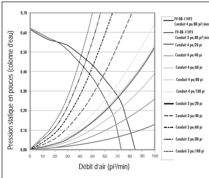
Courbe de rendement FV-08-11VF5 - 110 pi³/min
