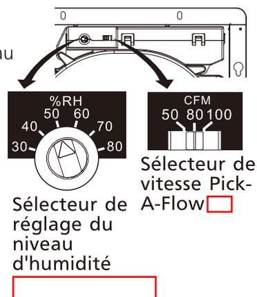
\*2 L'appareil continue de fonctionner pendant environ 20 minutes lorsqu'il détecte que le taux d'humidité de l'environnement est inférieur d'environ 5 % de celui du réglage d'humidité, avant l'arrêt.
