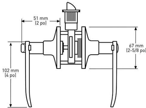
LOQUET 6-EN-1 À ENFONCEMENT/À MORTAISE CARRÉE/À MORTAISE ARRONDIE À 45°
