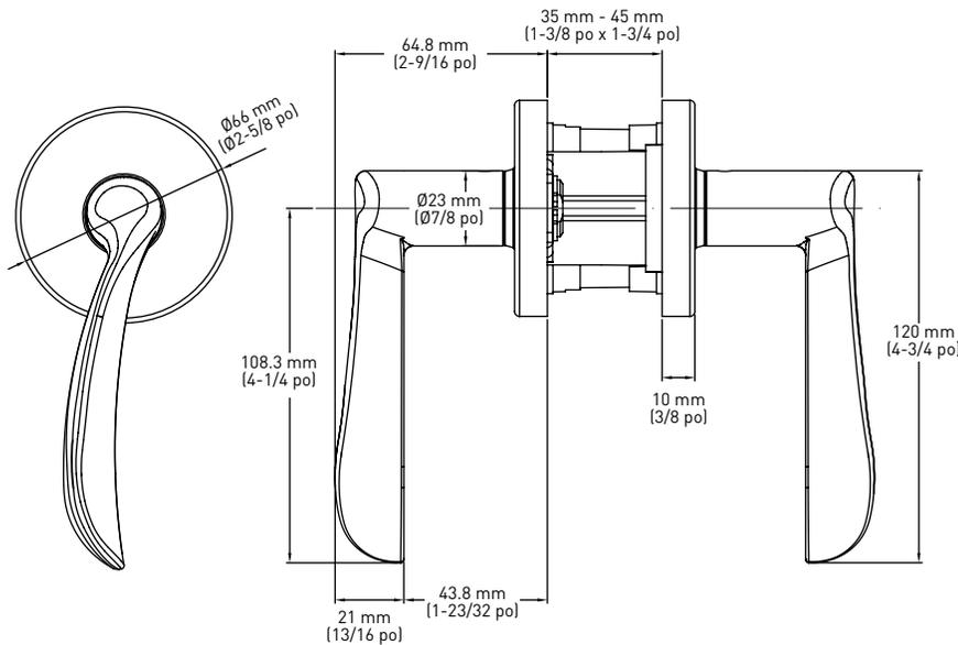
LOQUET 6-EN-1 À ENFONCEMENT/À MORTAISE CARRÉE /À MORTAISE ARRONDIE À 45°
