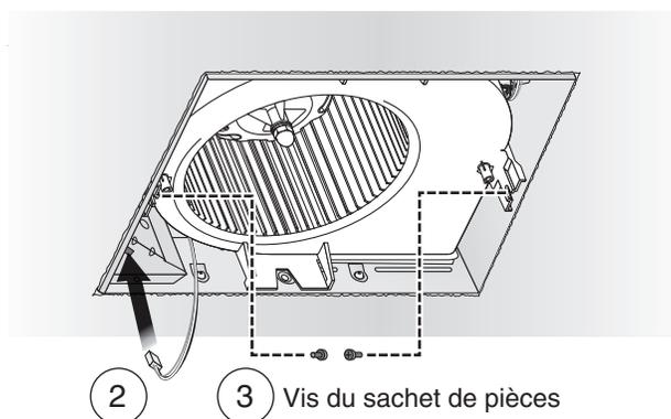
S'il faut réparer le plafond, mettre le masque dans le boîtier après fixation de l'ensemble ventilateur.
