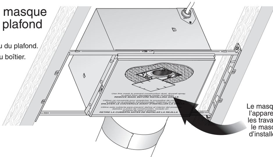
Le masque protège l'appareil pendant les travaux. Retirer le masque avant d'installer la grille.
