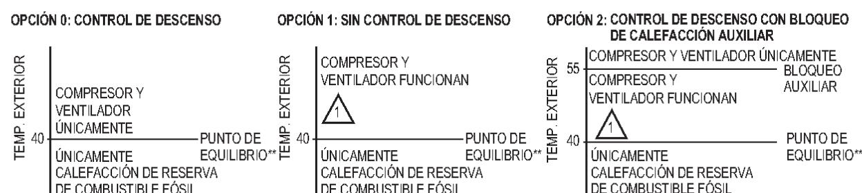
⚠ SI LA TEMPERATURA DE LA HABITACIÓN DESCENDE (EXcede LA CONFIGURACIÓN DE DESCENSO EN LA FUNCIÓN 20), EL COMPRESOR SE DESACTIVA. LA CALEFACCIÓN DE RESERVA DE COMBUSTIBLE FÓSIL SE ACTIVA DESPUÉS DE UN RETARDO DE 3 MINUTOS.
