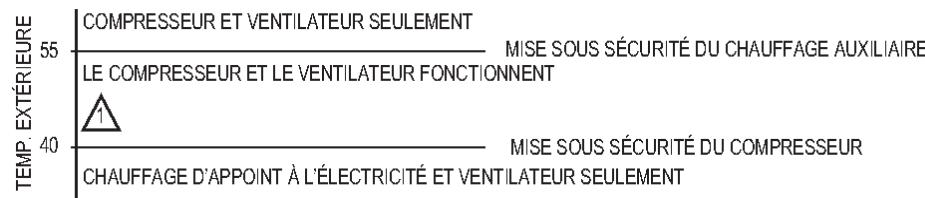
**⚠** SI LE COMPRESSEUR NE PEUT ATTEINDRE OU MAINTENIR LA TEMPÉRATURE DE CONSIGNE, LE COMPRESSEUR ET LE SYSTÈME DE CHAUFFAGE D'APPONT FONCTIONNERONT TOUS DEUX. MF28705
